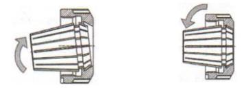
Spannzange schräg zur Spannmutter ansetzen und durch Druck von oben / seitlich einrasten.
